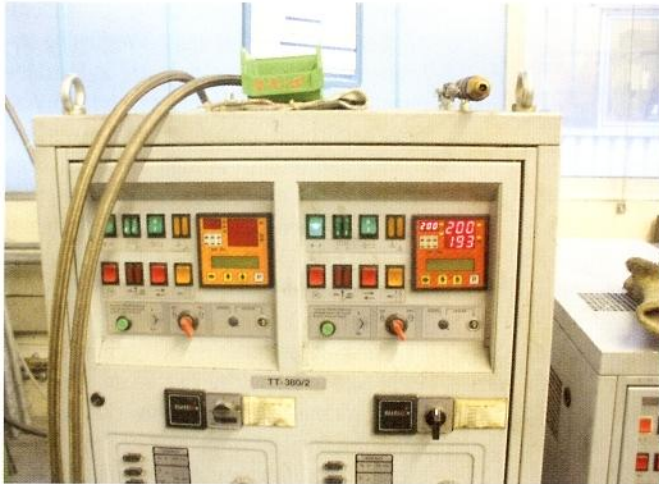
Bild 2: Aufheizung der Proben mit dem Temperiersystem Tool Temp TT 380/2
