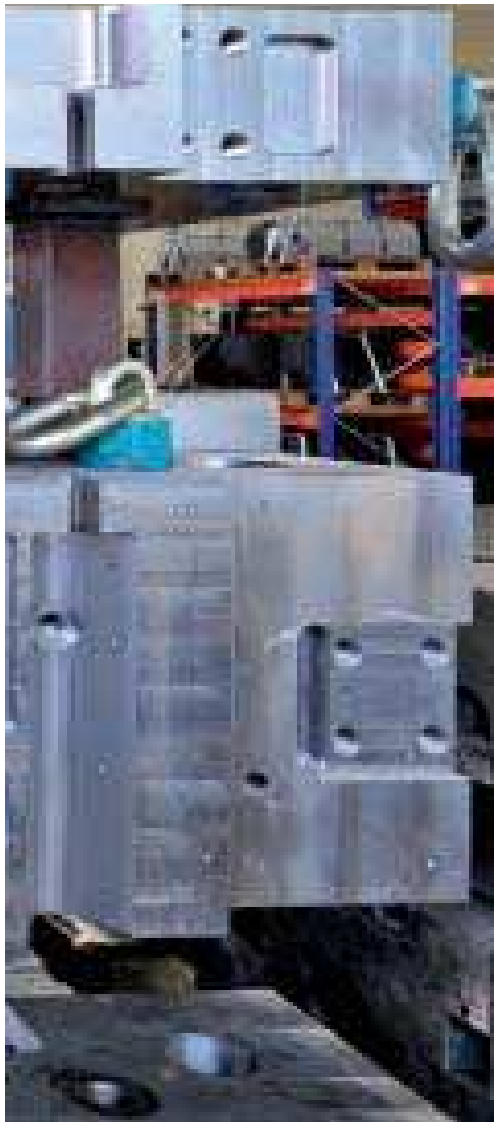
Formaufbau für einen Längsträger in der Montage von Schaufler Tooling.
