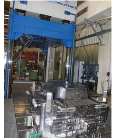
An den Säulen der Presse wurden die Faltenbälge weggelassen – das bringt rund 350 mm mehr Hub.
