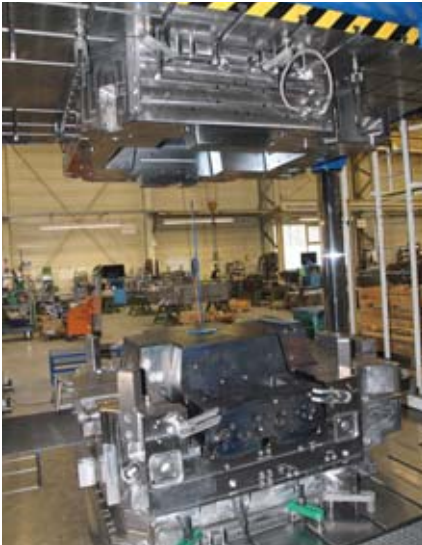
Fast schon wieder filigran wirkt die große Druckgussform auf der Presse.
