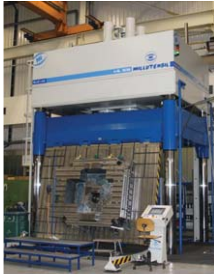
Die Millutensil ist in den Boden eingelassen. So ist der untere Pressentisch in einer Ebene mit dem Hallenboden.
