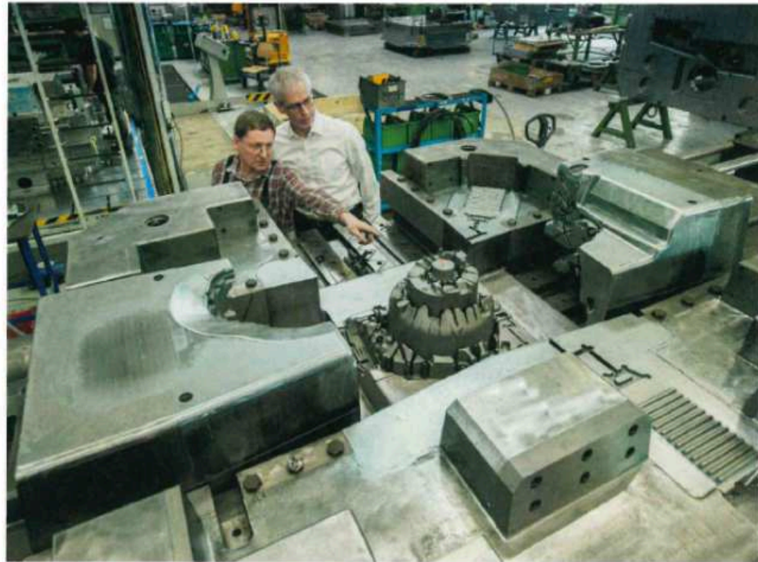
Das Innere einer Druckgießform.
